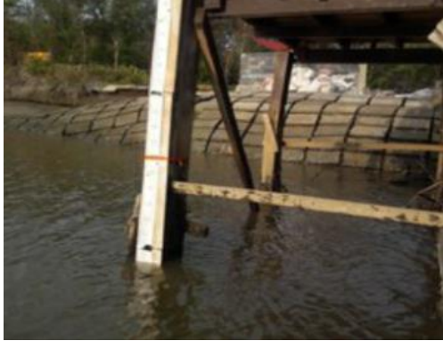
Gambar 1. Pengamatan Pasang Surut untuk Pengukuran Batimetri
