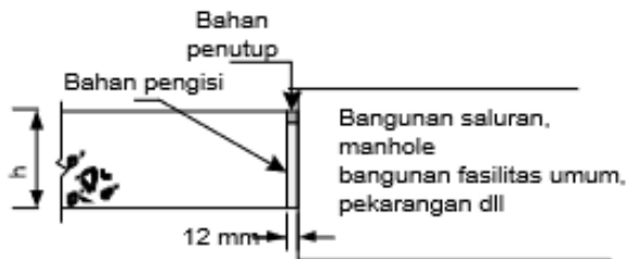
c) SAMBUNGAN ISOLASI TANPA RUJI
