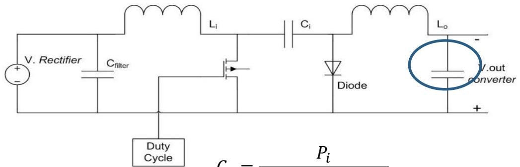
$$\begin{aligned} C_{o.1} &= \frac{P_{max}}{2 \cdot \pi \cdot f \cdot \eta_4 \cdot V_{o,max}^2} \\ &= \frac{900}{2 \cdot 3.14 \cdot 50 \cdot 0.1 \cdot 110^2} \\ &= 2.37 mH \end{aligned}$$
