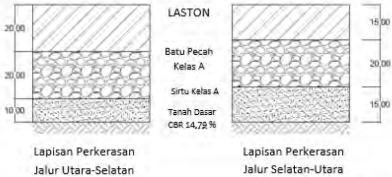
Gambar 7.2 Tebal Lapisan Perkerasan
