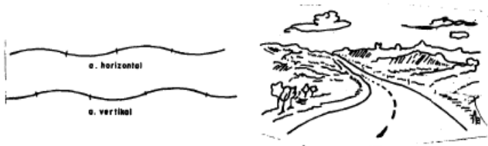
Gambar 2. 24 Kombinasi Lengkung Vertikal Cekung Pada Jalan Yang Lurus dan Panjang
