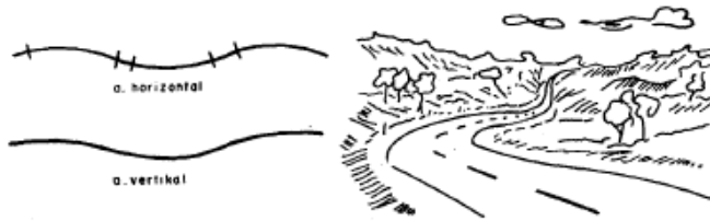
Gambar 2. 22 Koordinasi Ideal Antar Alinyemen Horizontal Dan Alinyemen Vertikal
