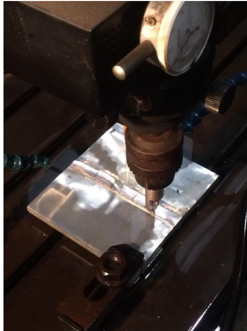
Gambar III.21 Proses Pembuatan Crack Dengan Mesin EDM
