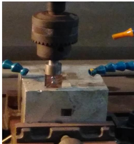
Gambar III.17 Tool EDM Yang digunakan Untuk Pembuatan Retak
