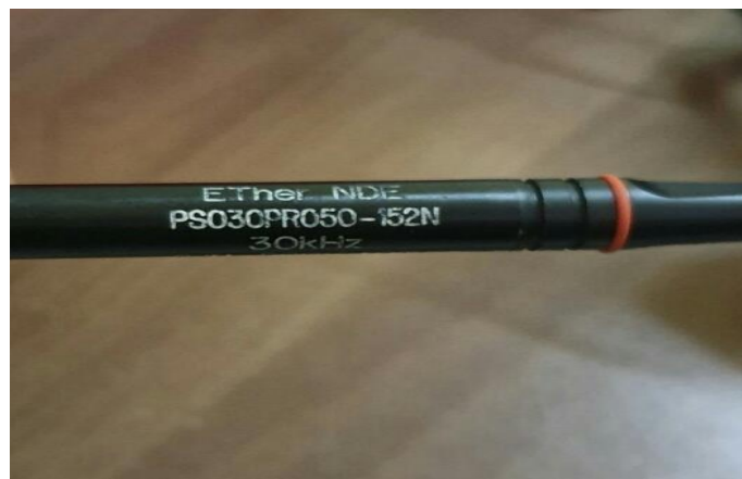
Gambar II.3 Probe Frekuensi 30 kHz
