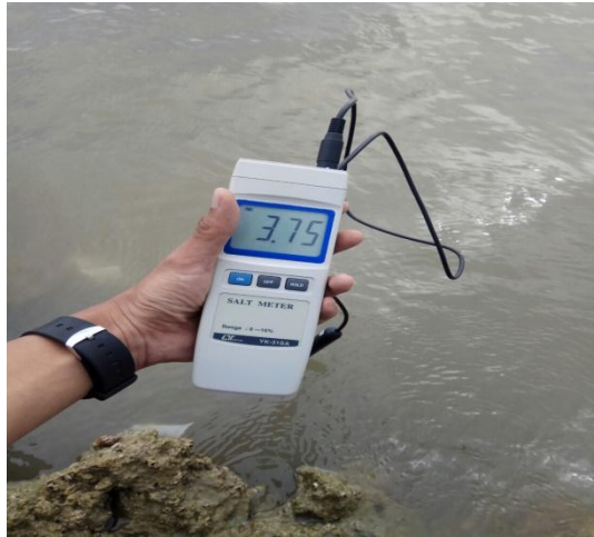
Gambar 3.18 Pengukuran persentase kadar salinitas air menggunakan saltmeter
