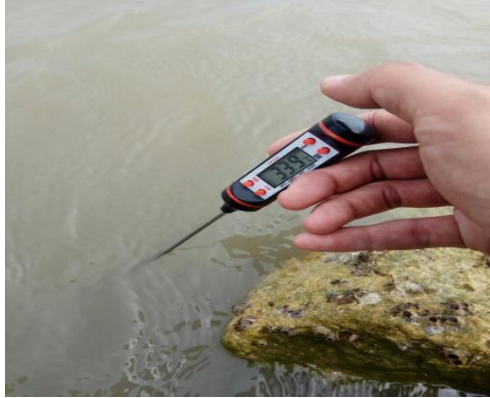
Gambar 3.16 Pengukuran menggunakan sensor temperatur, suhu air diukur secara langsung
