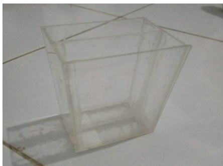
Gambar 3.8 Wadah sel terdiri dari 2 unit reaktor
