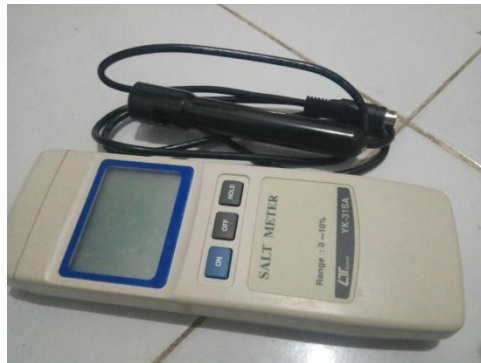
Gambar 3.13 alat pengukur salinitas merk Lutron
