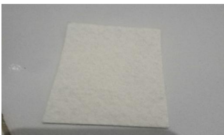
Gambar 3.11 Lembaran separator sebagai pemisah elektroda
