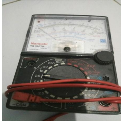
Gambar 3.12 Avometer untuk mengukur tegangan dan arus keluaran
