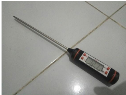
Gambar 3.15 Termometer digital untuk air dan larutan
