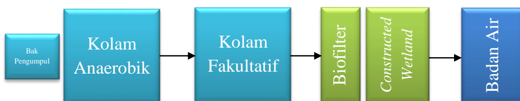
Gambar 8.1. Instalasi Pengolahan Lindi TPA Cahaya Kencana
