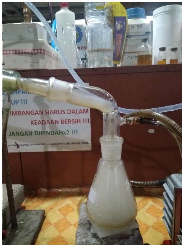
Gambar E.5. Gas yang dihasilkan dari microwave-assisted pyrolysis
