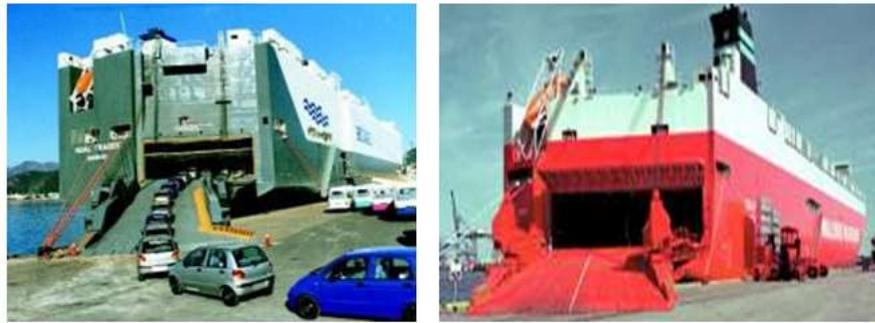
Gambar II.3 Pintu Rampa Pada kapal Ro-Ro
