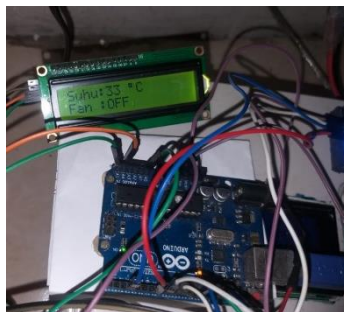
Gambar 4. 5 Rangkaian Pengujian LCD
