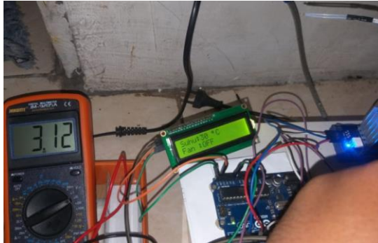
Gambar 4. 2 Metode Pengujian sensor NTC3950
