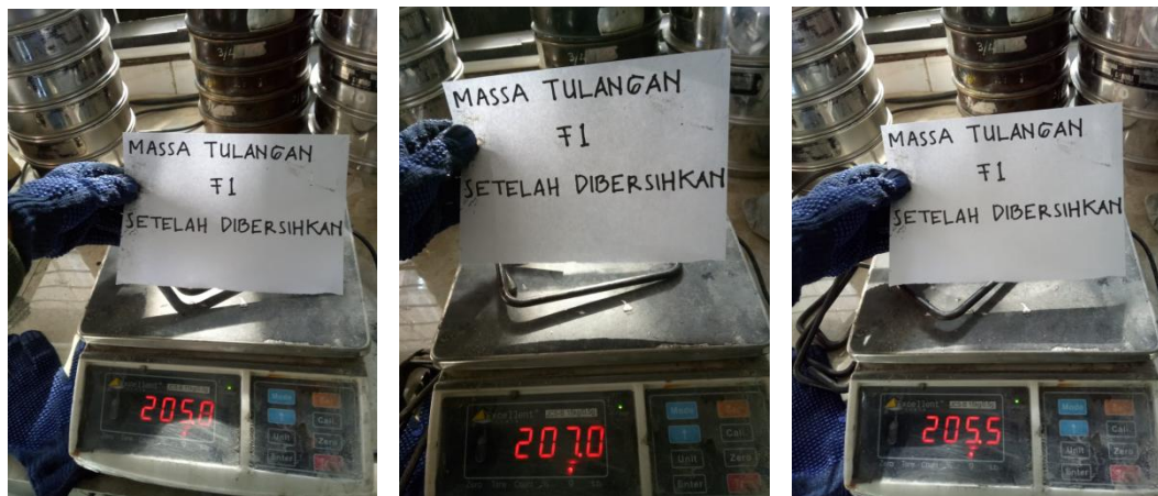
Foto Massa Tulangan Senggang Balok Normal (F1) Setelah Dibersihkan
