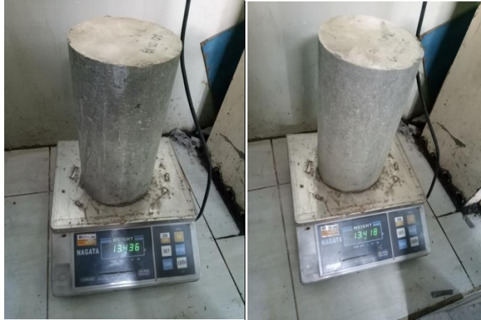
Foto Penimbangan Benda Uji Silinder 10 x 20 cm
