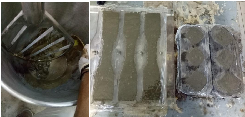
Foto Pengecoran dan Pembuatan Benda Uji Dog Bone dan Silinder 5 x 10 cm
