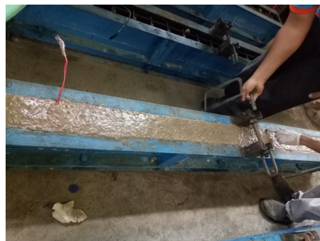
Foto Pengecoran dan Pembuatan Benda Uji Balok
