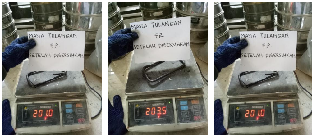
Foto Massa Tulangan Senggang Balok Supplementary (F2) Setelah Dibersihkan
