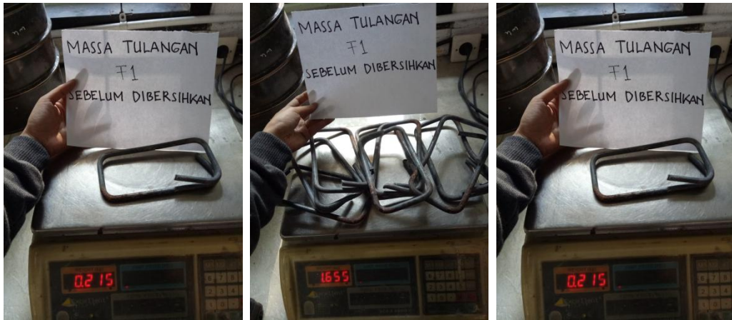
Foto Massa Tulangan Senggang Balok Normal (F1) Sebelum Dibersihkan
