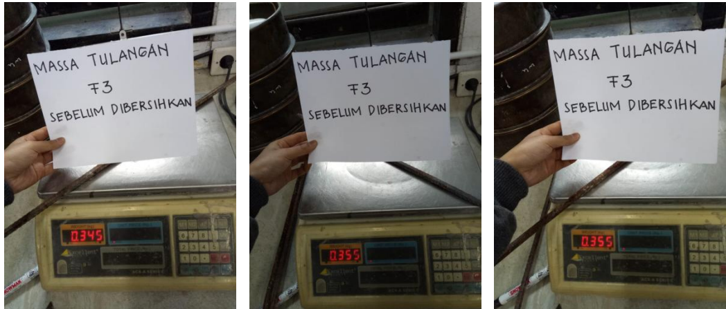
Foto Massa Tulangan Memanjang Balok ECC (F3) Sebelum Dibersihkan
