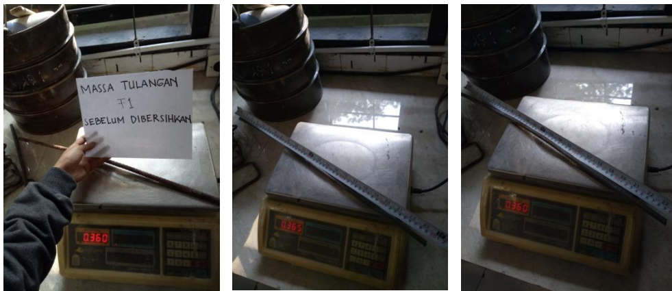
Foto Massa Tulangan Memanjang Balok Normal (F1) Sebelum Dibersihkan
