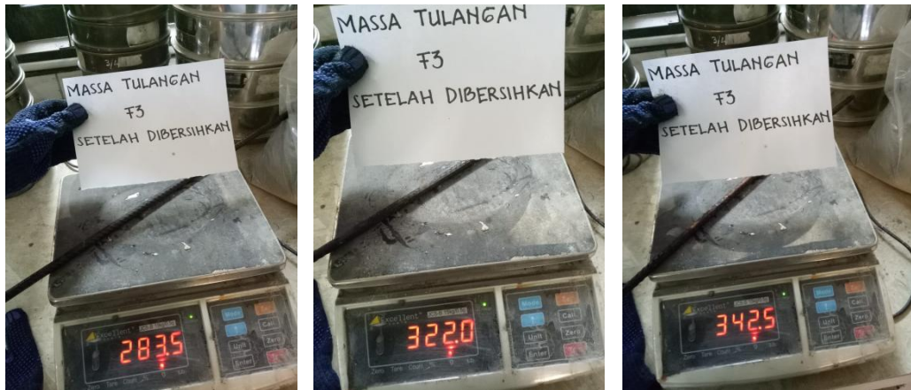
Foto Massa Tulangan Memanjang Balok ECC (F3) Setelah Dibersihkan
