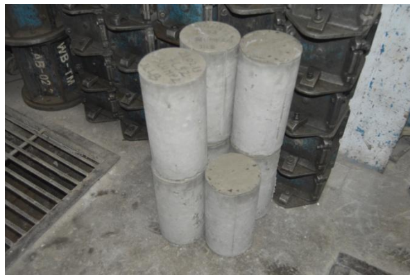
Foto Pengecoran dan Pembuatan Benda Uji Silinder 10 x 20 cm
