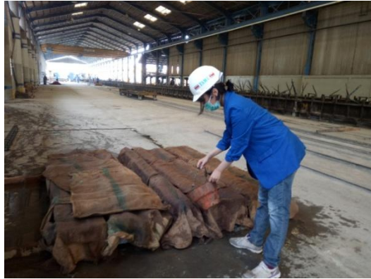
Foto Perawatan ( Moist Curing ) Benda Uji Balok
