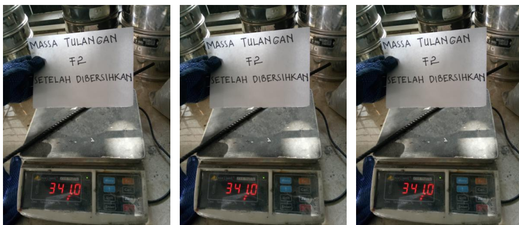
Foto Massa Tulangan Memanjang Balok Supplementary (F2) Setelah Dibersihkan
