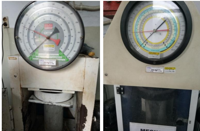
Foto Pengujian Kuat Tekan Silinder 10 x 20 cm
