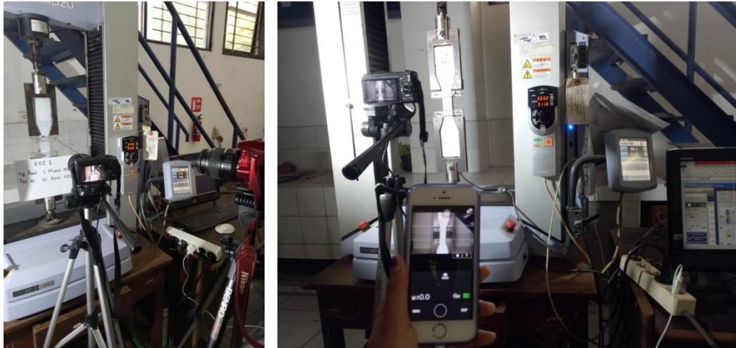
Foto Set-Up Pengujian Tarik Dog Bone
