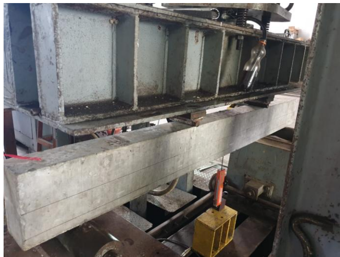
Foto Pembuatan Pre-Crack
