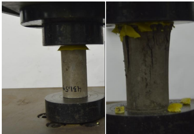
Foto Pengujian Kuat Tekan Silinder 5 x 10 cm
