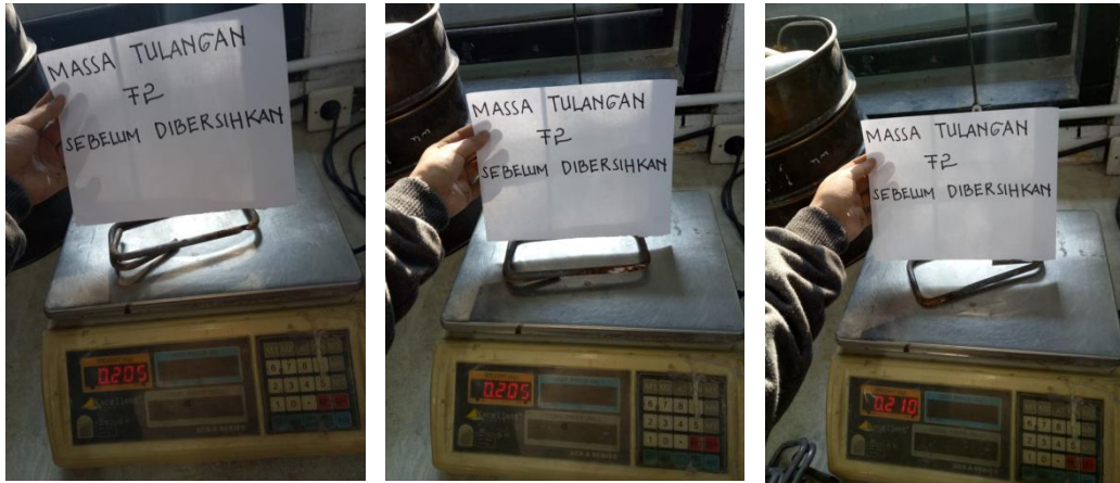
Foto Massa Tulangan Senggang Balok Supplementary (F2) Sebelum Dibersihkan
