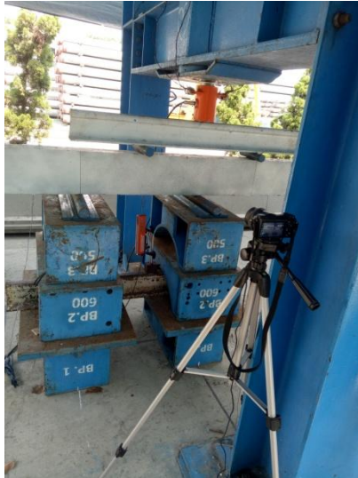
Foto Set-Up Pengujian Balok Kontrol 200 x 10 x 20 cm
