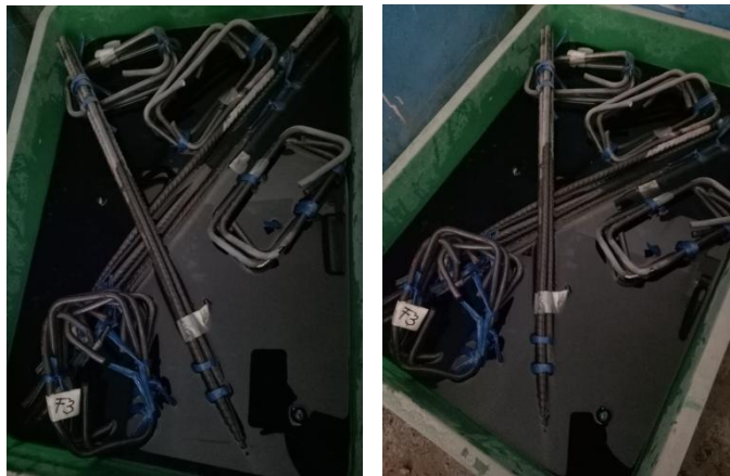
Foto Perendaman Tulangan Ke Dalam Larutan Penghilang Karat
