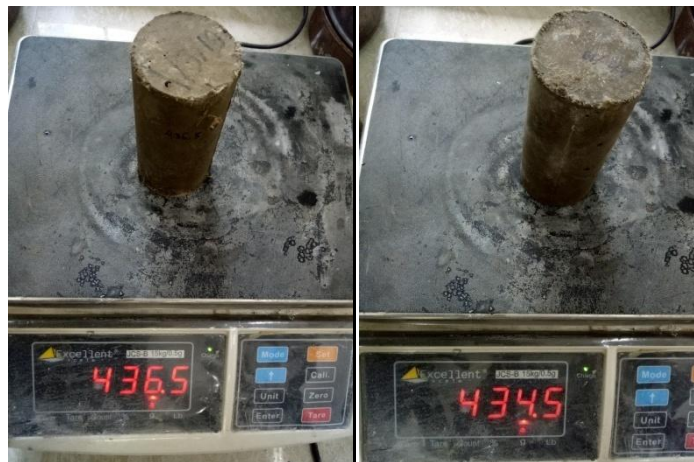
Foto Penimbangan Benda Uji Silinder 5 x 10 cm
