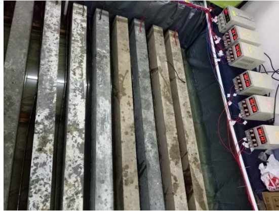
Foto Set-Up Metode Galvanostatik Untuk Mempercepat Korosi
