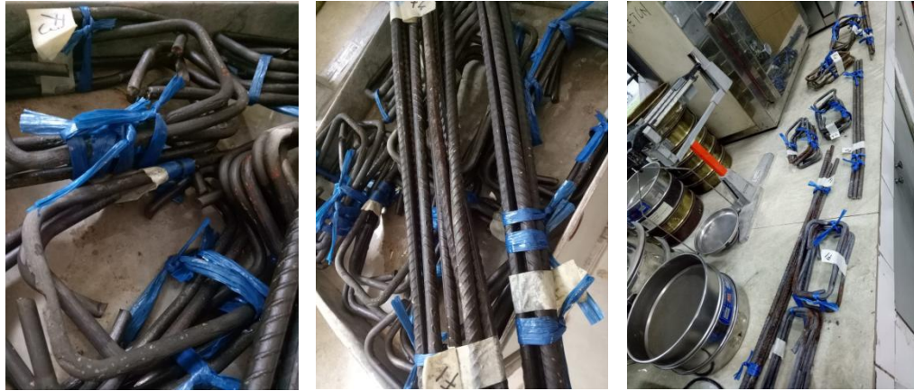
Foto Tulangan Yang Telah Dibersihkan Setelah Perendaman
