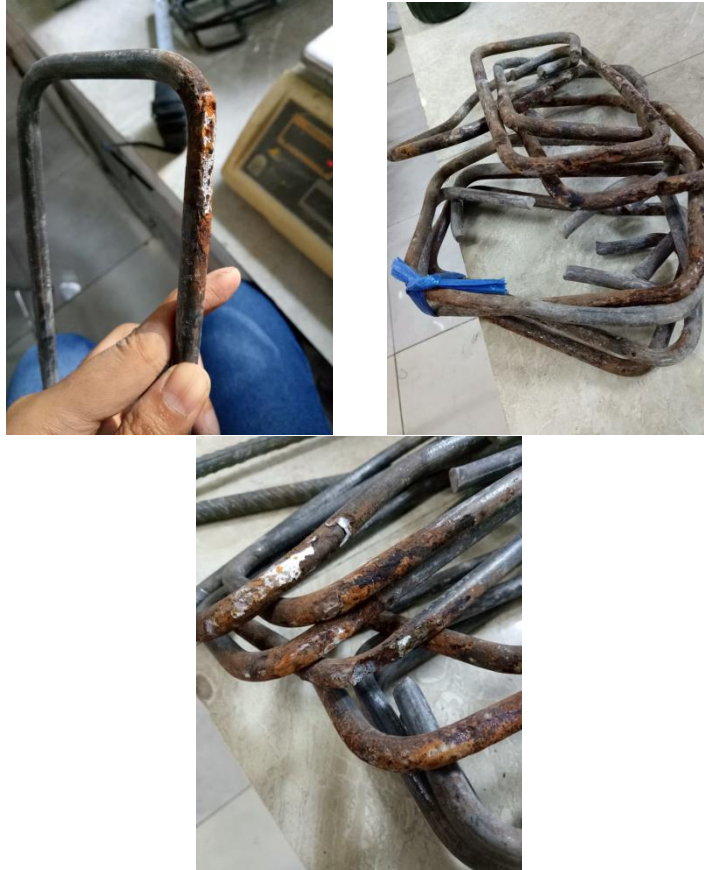
Foto Contoh Korosi Pada Tulangan Sengkang Sebelum Dibersihkan
