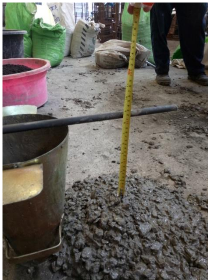
Foto Penentuan Nilai Slump
