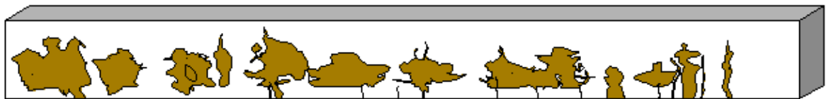
Gambar4.22 Balok ECC korosi minggu keempat
