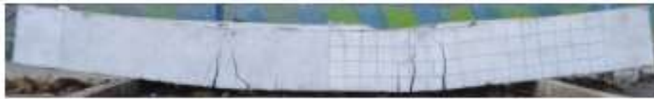
Gambar Balok ECC setelah Pengujian Four Point Bending
