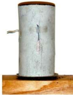
Gambar 4.3. Benda Uji ECC setelah di uji tekan (Wang and Li, 2007)
