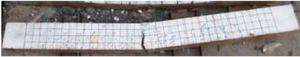
Gambar Balok ECC setelah pengujian four point bending
