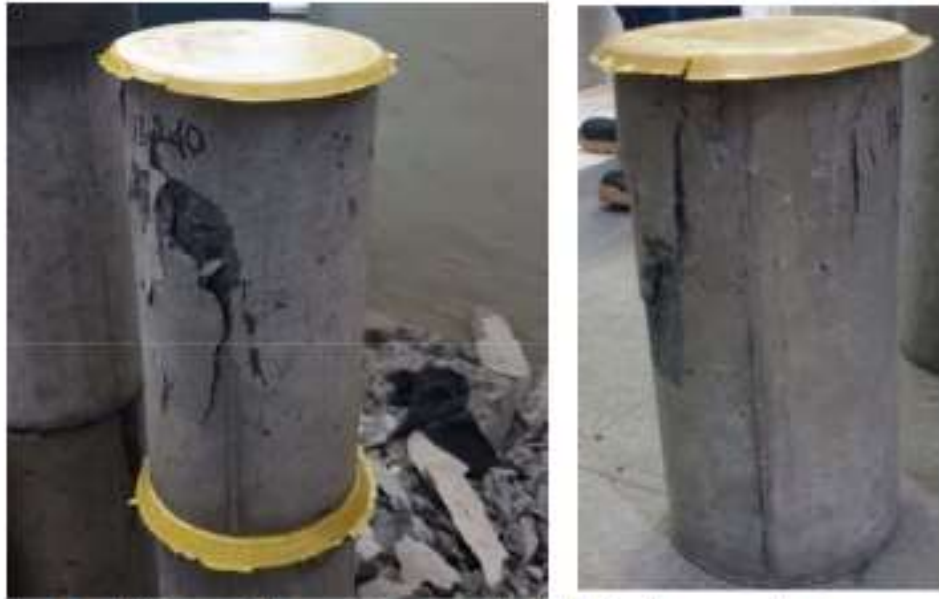
Gambar Silinder setelah Pengujian Kuat Tekan Silinder beton NC dan beton SMFA
