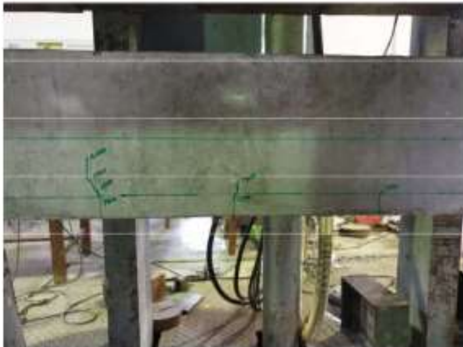
Gambar uji bending untuk memberikan retak (pre-crack) pada beton
