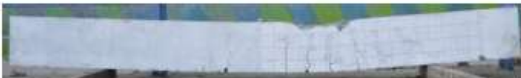
Gambar Balok Beton konvensional (NC) setelah Pengujian Four Point Bending
