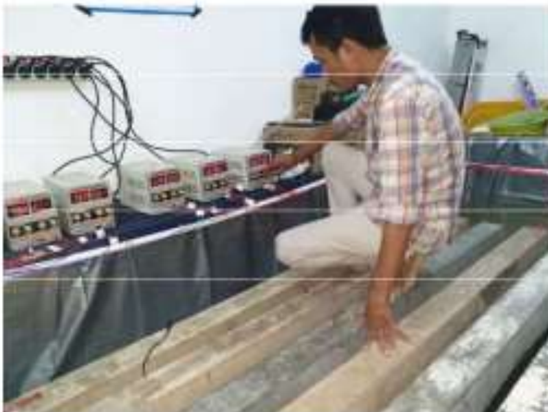
Gambar Mengatur Arus di Power Supply
