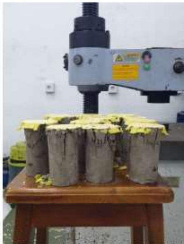
Gambar Silinder setelah Pengujian Kuat Tekan Silinder ECC
