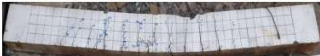
Gambar Balok NC setelah pengujian four point bending
