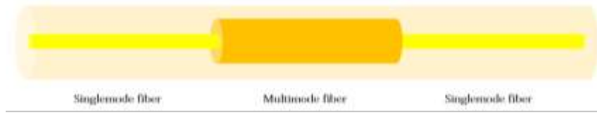
Gambar 2. 10 Serat optik berstruktur SMS
