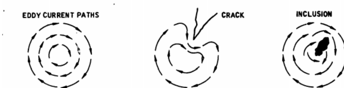
Gambar II.3 Pola arus eddy ketika tidak ada retak, ada retak, dan inclusion Sumber: Marshal, 1967
