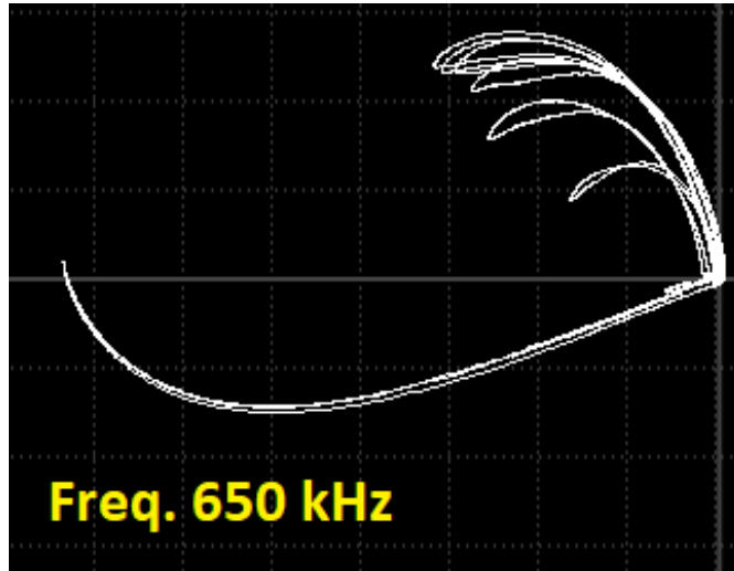
Gambar IV.4 Hasil pengujian pada blok kalibrasi menggunakan frekuensi 650 kHz
