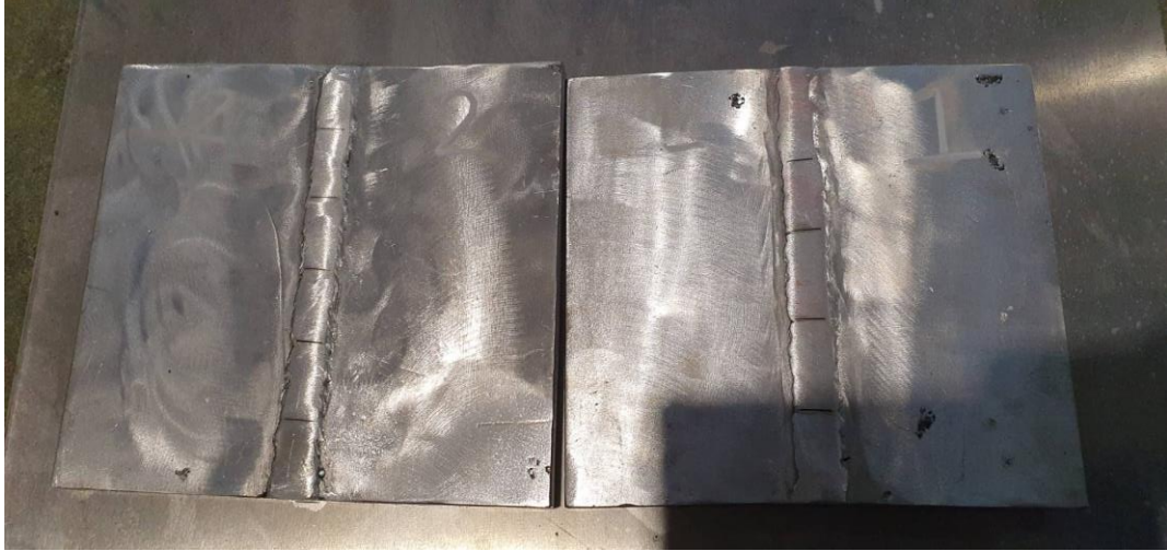
Gambar III.19 Contoh material uji yang sudah diberi retak buatan
