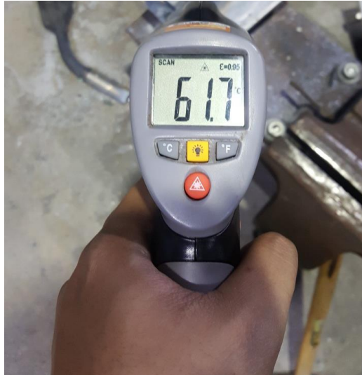
Gambar III.9 Suhu material saat diukur dengan Infrared Thermometer
