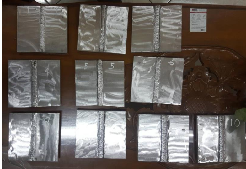
Gambar III.11 Material hasil pengelasan butt joint setelah dibersihkan
