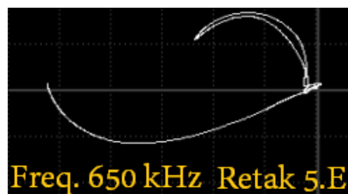
Gambar IV.24 Hasil Pengujian eddy current pada test piece 5 menggunakan probe 650 kHz
