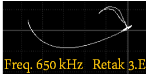
Gambar IV.16 Hasil Pengujian eddy current pada test piece 3 menggunakan probe 650 kHz
