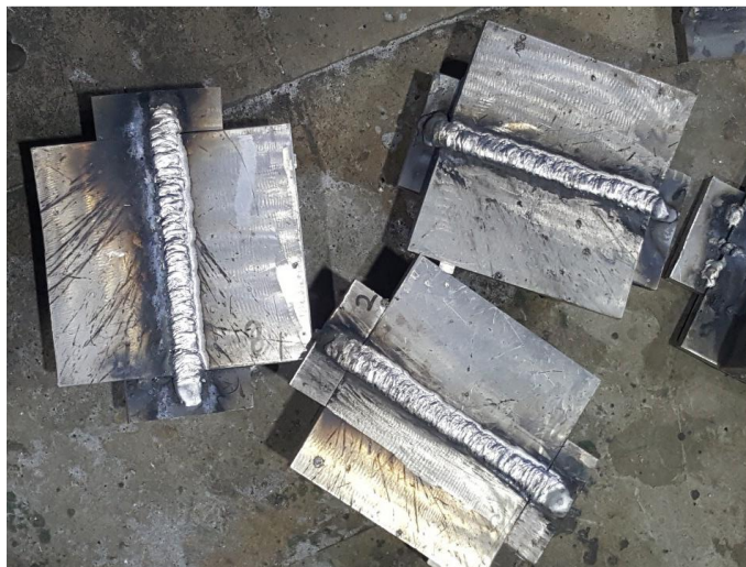
Gambar III.10 Hasil pengelasan butt joint sebelum dibersihkan
