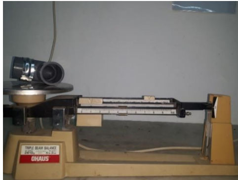
Gambar 3.25 Massa utama(Pipa elbow 90°) dan clamp
