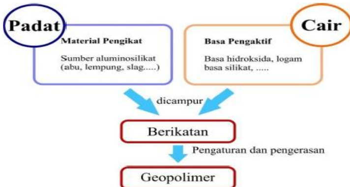
Gambar 2.1 Skema diagram pembentukan geopolimer (Yun-Ming, et al. , 2016)
