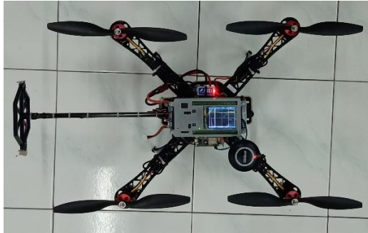
Gambar III.3 UAV membawa perangkat lokalisasi suara
