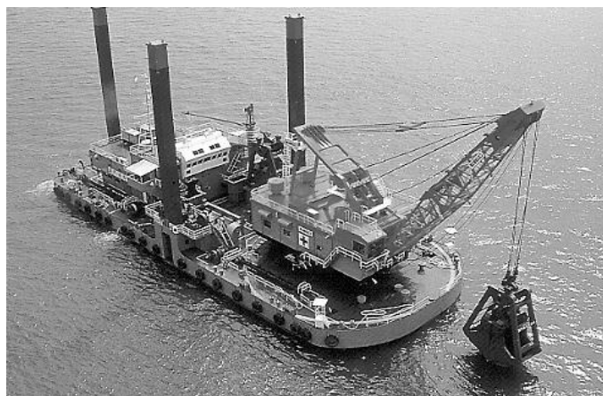
Gambar 2. 2 Grab Dredger/ Clam Shell (Vlasblom, 2003)
