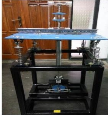
Gambar 3. 4 Mekanisme sistem utama dengan penambahan CPVA
