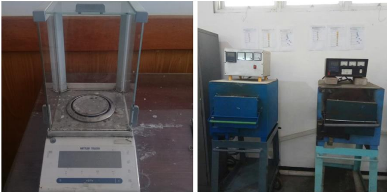
Gambar 3. 5 Alat pengujian oksidasi temperatur tinggi
