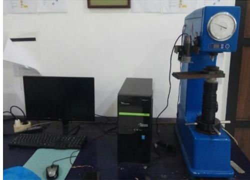
**Gambar 3.3** Alat uji kekerasan (Dokumentasi Pribadi)
