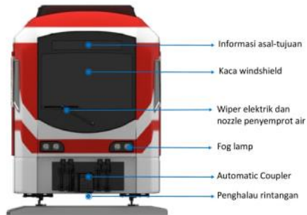
Gambar 2.4 Ukuran Carbody LRT Palembang (Dok. PT INKA)
