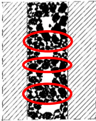
Gambar 2.7 Pembentukan jembatan saat mengisi serbuk (Höganäs, 2013)
