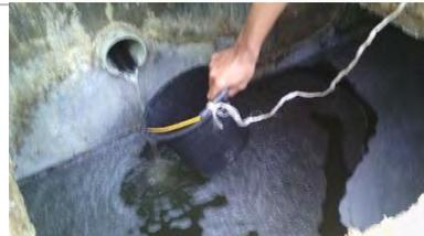
Gambar C12. Pengambilan Sampel Air Limbah Outlet dan Pengukuran Debit Eksisting IPAL Singosari 3
