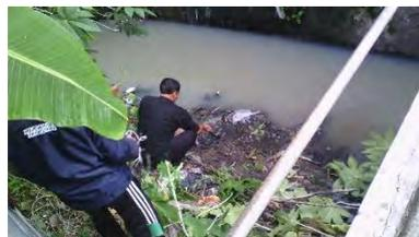
Gambar C18. Pengambilan Sampel Air Limbah Outlet Dan Pengukuran Debit Eksisting IPAL Bedilan
