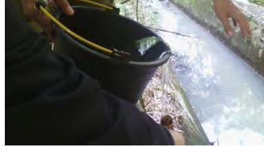
Gambar C20. Pengambilan Sampel Air Limbah Outlet Dan Pengukuran Debit Eksisting IPAL Karangturi
