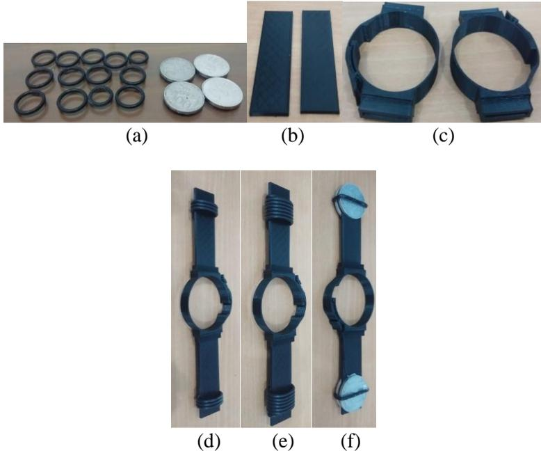
**Gambar 4.3** Komponen DVA (a) massa pemberat berupa *ring* karet dan koin, (b) *beam*, (c) *clamp*, (d) rasio massa DVA 1/30 dari massa utama, (e) rasio massa DVA 1/20 dari massa utama, (f) rasio massa DVA 1/10 dari massa utama
