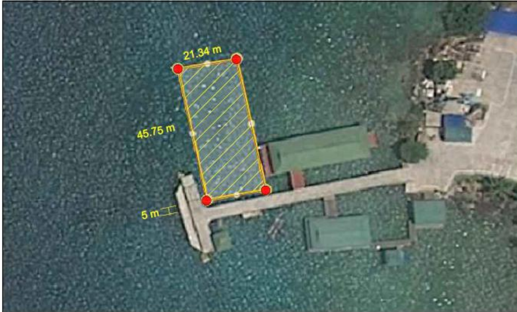
Gambar 5. 31 Rencana Pencanaan Spud Pada Pelabuhan Matak
