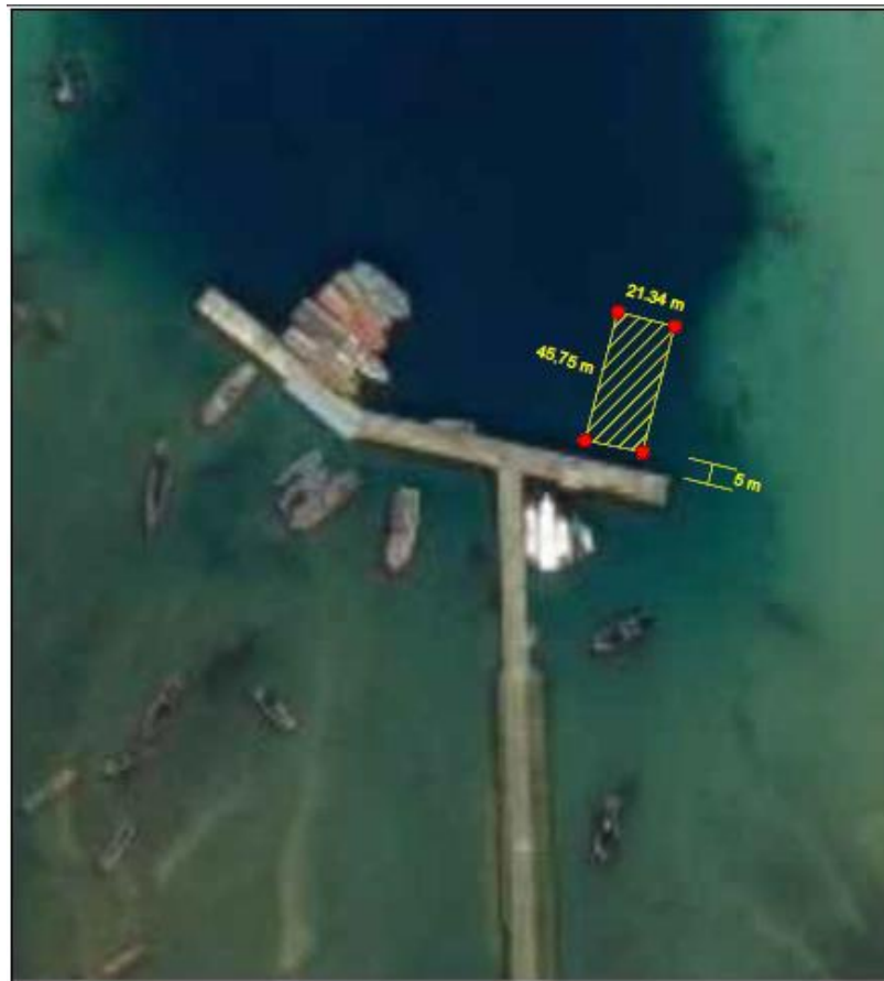
Gambar 5. 30 Rencana Pencanaan Spud Pada Pelabuhan Tarempa
