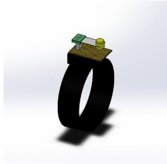
Gambar 3. 4 (a) Minisense 100 vibration sensor (b) Cantilever piezoelectric dipasang pada klem
