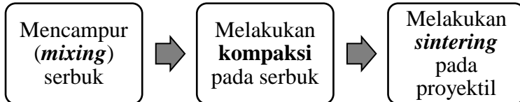
Gambar 2.2 Proses Manufaktur Proyektil Frangible Metode Metalurgi Serbuk (ASM Metal Handbook , 1998)
