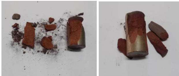
Gambar 4.14 Kondisi sampel setelah uji kekuatan tekan
