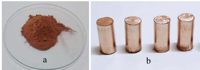
Gambar 4.5 Sampel uji kinerja (a) serbuk sebelum kompaksi (b) pellet setelah kompaksi
