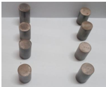
Gambar 4.13 Sampel uji tekan komposit Cu-Sn setelah disintering
