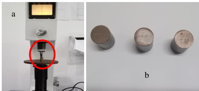
Gambar 4.9 a) Pengujian kekerasan dengan metode rockwell F, b) sampel hasil uji kekerasan
