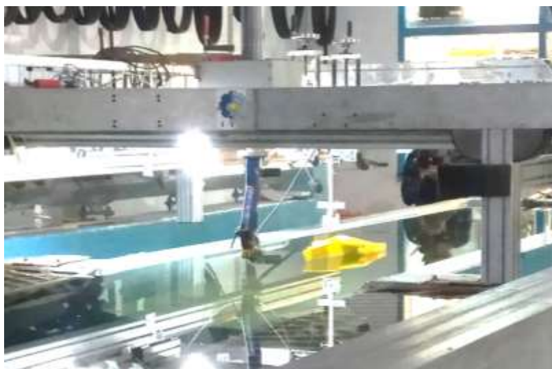
Gambar 3.2 Pengujian eksperimen seakeeping trimaran USV
