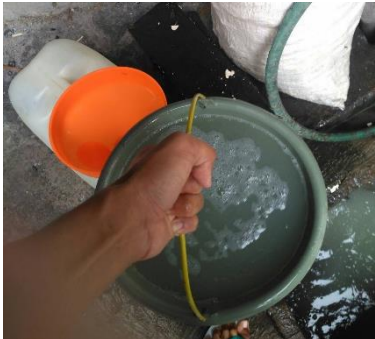
Gambar 3.9 Proses Pengambilan Sampel Menggunakan Timba
