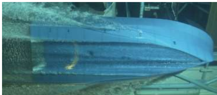
Gambar II.4 Tank test pada ASV mono-hull
