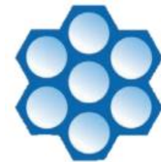
Gambar 2. 7 Skema pori dari silika MCM-41 (Erwa S. 2016)
