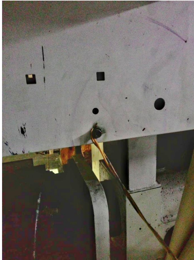
Gambar 5.11. penghubungan kabel ke badan mesin agar tertanahkan dengan baik
