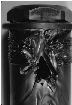
Gambar 2.6 Korosi Erosi pada komponen baja
