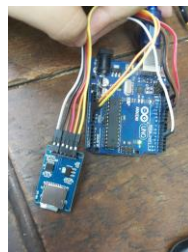
Gambar 3. 4 Sambungan dari Arduino ke Module SD Card
