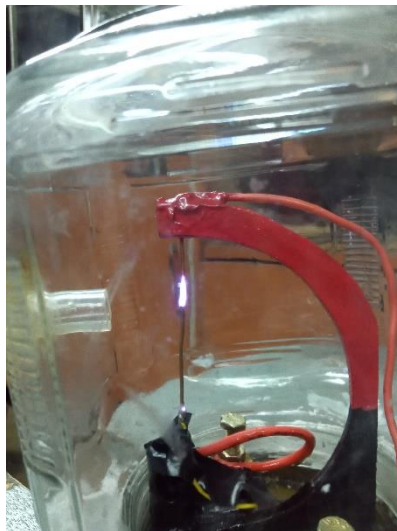
Gambar 2. Plasma pada Jarak Elektroda 10 mm.
