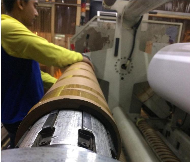
Gambar 4.16. (a) Pengambilan *core* (b) Pemasangan *core*
