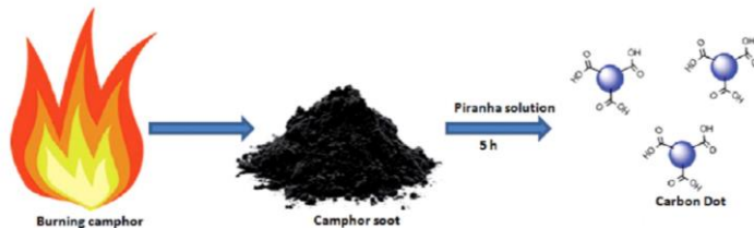
Gambar 2.7 Proses dekomposisi kamper menjadi nanomaterial (Gaddam dkk, 2015)
