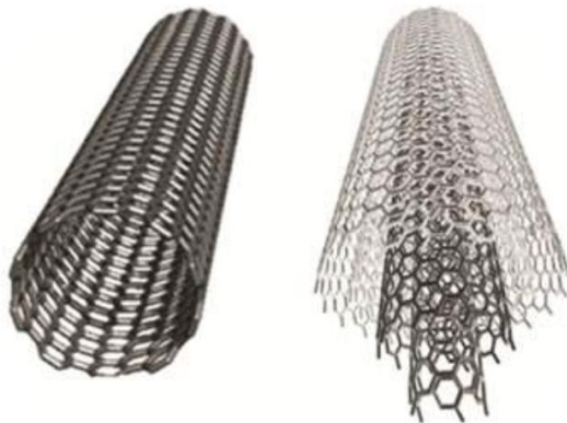
Gambar 2.5 Struktur material CNT dinding tunggal (kiri) dan dinding ganda (kanan) (Razali dkk, 2016)
