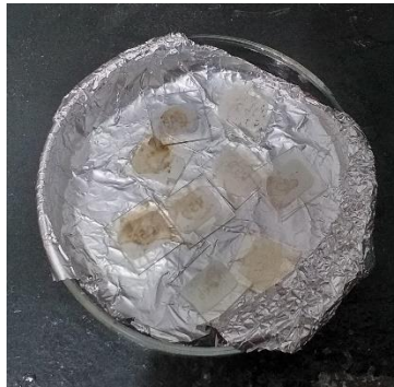
Gambar 3.4 Sampel film tipis CuO hasil annealing suhu 400°C, 500°C dan 600°C.
