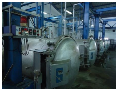
Gambar 2. 11 Kaleng dimasukkan ke dalam retort
