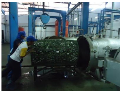
Gambar 2. 11 Kaleng dimasukkan ke dalam retort
