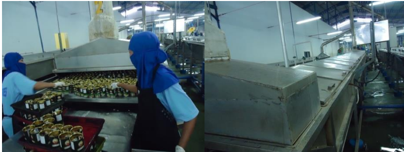
Gambar 2. 7 Proses pemasukan kaleng pada exhaust box Sumber : PT. Maya Food Industries (2014)
