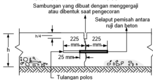
Gambar 3. 9 Sambungan susut melintang dengan ruji
