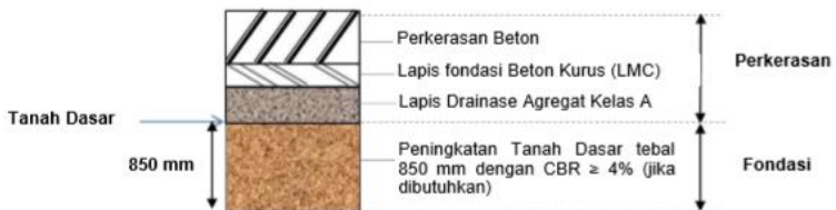
Gambar 3. 2 Tipikal Struktur Perkerasan Kaku.
