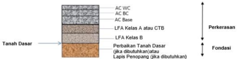
Gambar 3. 1 Tipikal Struktur Perkerasan Lentur
