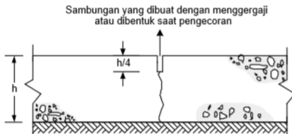
Gambar 3. 8 Sambungan susut melintang tanpa ruji
