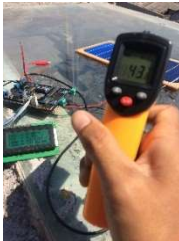
Gambar 3. 6 Pengukuran temperature cell pv menggunakan thermogun
