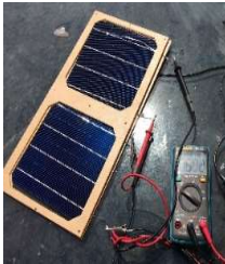
Gambar 3. 4 Pengukuran I_{sc} cell pv menggunakan multimeter digital
