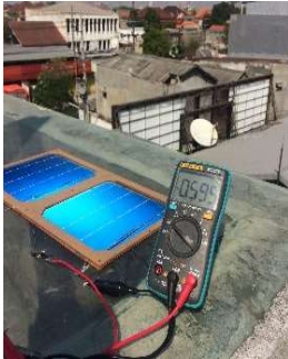
Gambar 3. 5 Pengukuran V_{oc} cell pv menggunakan multimeter digital
