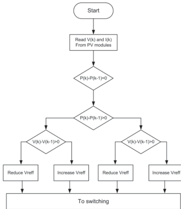
Gambar 2.8 Flowchart dari algoritma P&O [21]
