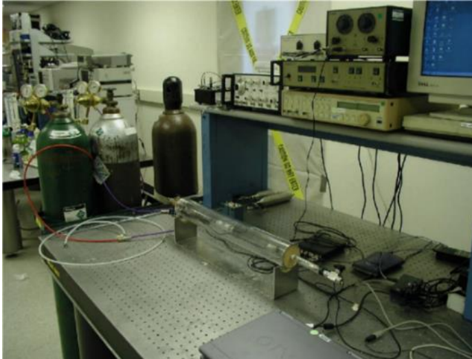
Gambar 2. 21 Eksperimen Getaran pada Pipa Plexiglas Menggunakan Fluida Gas Nitrogen (Sinha, 2005)
