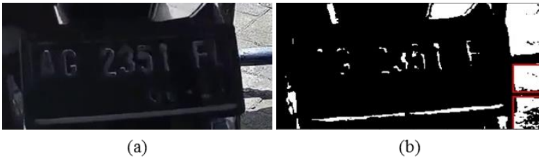
Gambar 5.18 Contoh gambar dari video 3 kondisi siang. (a) Gambar asli; (b) Gambar hasil segmentasi.
