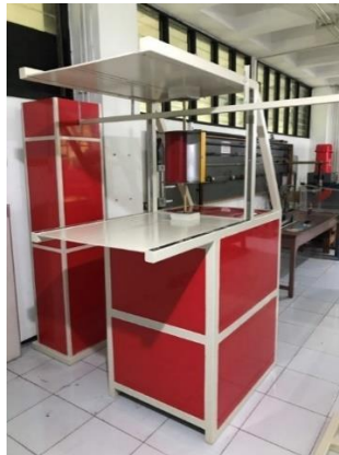
Gambar 3. 7 Penyangga Turbin Savonius
