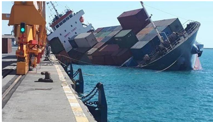
Gambar 2.4 kapal kehilangan buoyancy
