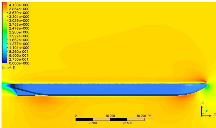
Gambar 4. 39 Result velocity kapal tanpa pelindung propeller dari samping
