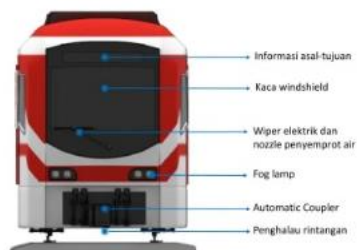
Gambar 3.16 Carbody LRT tampak depan (Dok. PT INKA)
