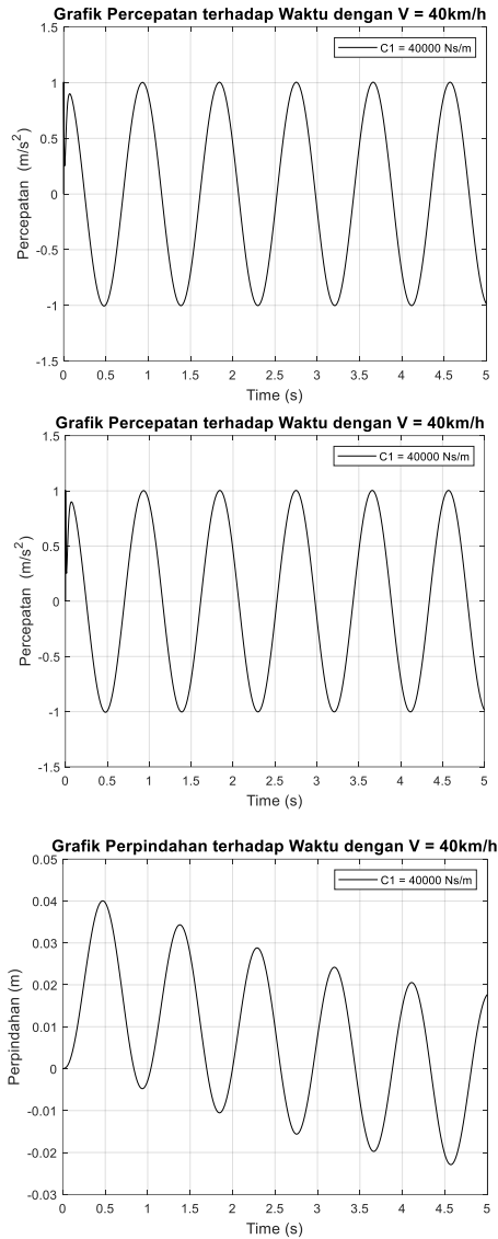
Gambar 9. Grafik Simulasi Mencari Nilai RMS pada V=40\text{ km/h}
