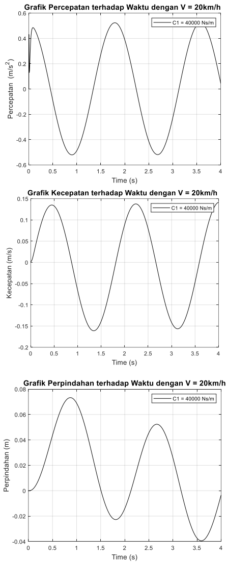
Gambar 7. Grafik Simulasi Mencari Nilai RMS pada V=20\text{ km/h}
