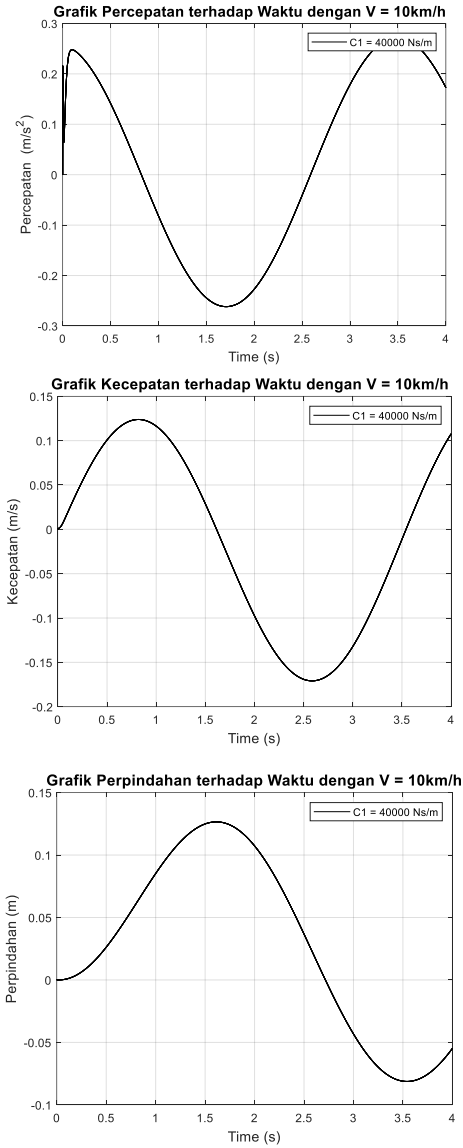
Gambar 6. Grafik Simulasi Mencari Nilai RMS pada V=10 km/h
